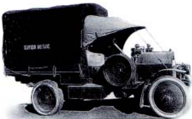
Первые грузовые автомобили строили просто: на большую легковую машину ставили кузов. Как раз таким был грузовик знаменитой итальянской фирмы ФИАТ, выпущенный в 1912 году.
